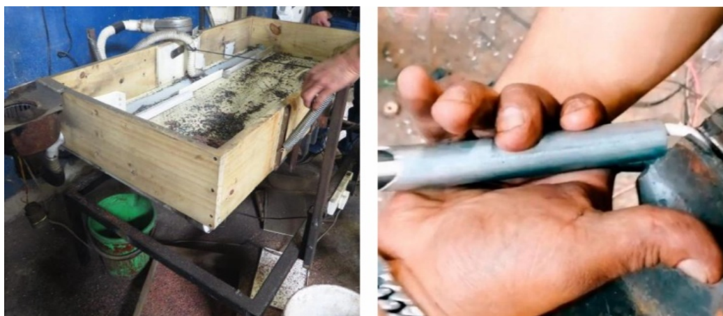
Fig nº 3. Mesa densimétrica y dispositivo pelacables, gentileza de Desechos Tecnológicos S.R.L. Fuente: Clinckspoor & Zulaica, 2022.
